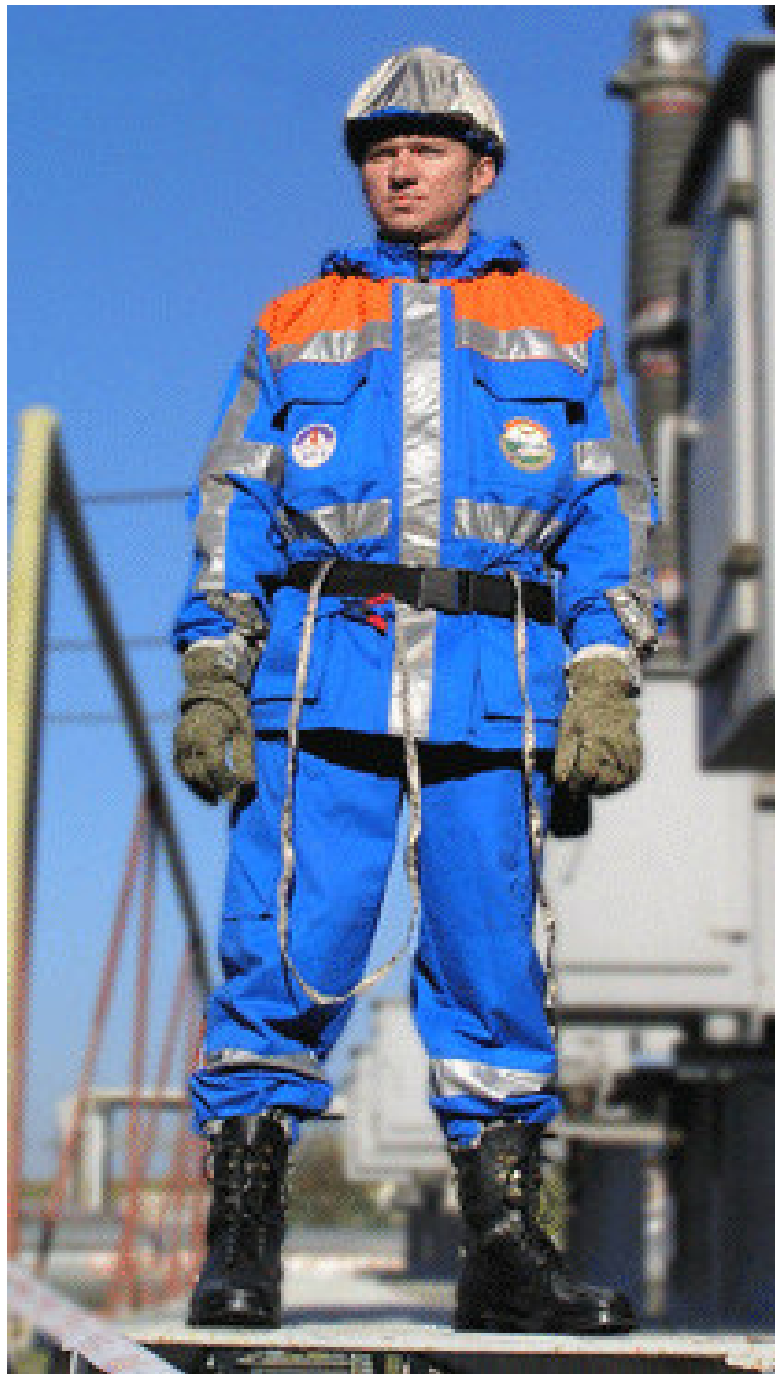
Рисунок 2.6 – Комплект экранизирующий ЭП-4(0)М для работ в зоне влияния электромагнитного поля
